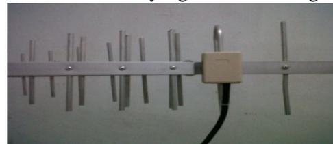
Gambar 11 *Driven element* dan reflektor antena yagi
